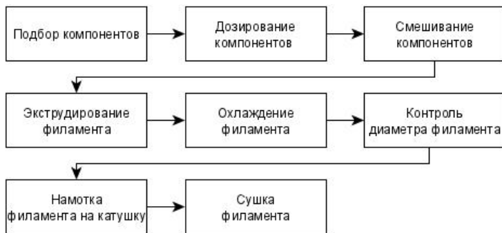
Рис. 1. Технологический процесс изготовления филамента
