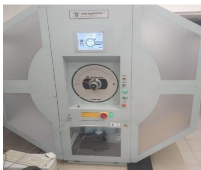
Рис. 2. Маятниковый копер ТСКМ – 300 (а) и установка образцов на опоры копра (б)
