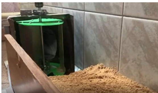
Рис. 2. Экспериментальная установка для исследования работы вертикального питателя (вид сбоку)
