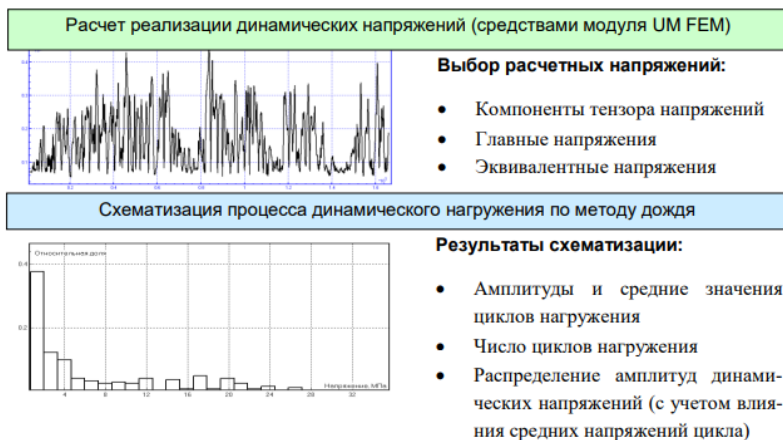
Рис. 16. Этапы анализа динамической нагруженности для частного режима эксплуатации
