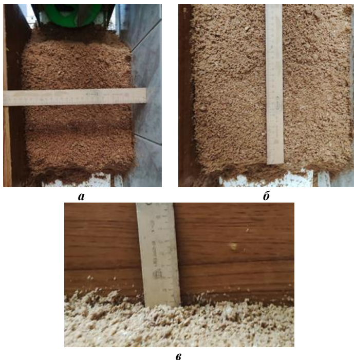
Рис. 4. Формирование призмы транспортируемого материала при работе вертикального питателя: a – длина призмы ( L , м); б – ширина призмы ( b , м); в – высота призмы ( h , м)
