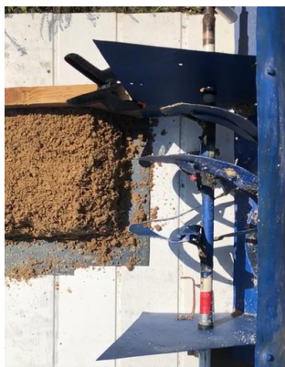
Рис. 1. Экспериментальная установка для исследования работы горизонтального питателя (вид сверху)
