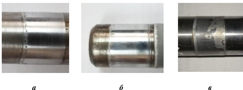
Рис. 4. Результаты испытания качества хромового покрытия в зависимости от касательного напряжения, МПа: a – 180, б – 270, в – 300
