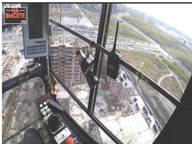
Рис. 3. Использование монокуляра и радиосвязи на высотном кране
