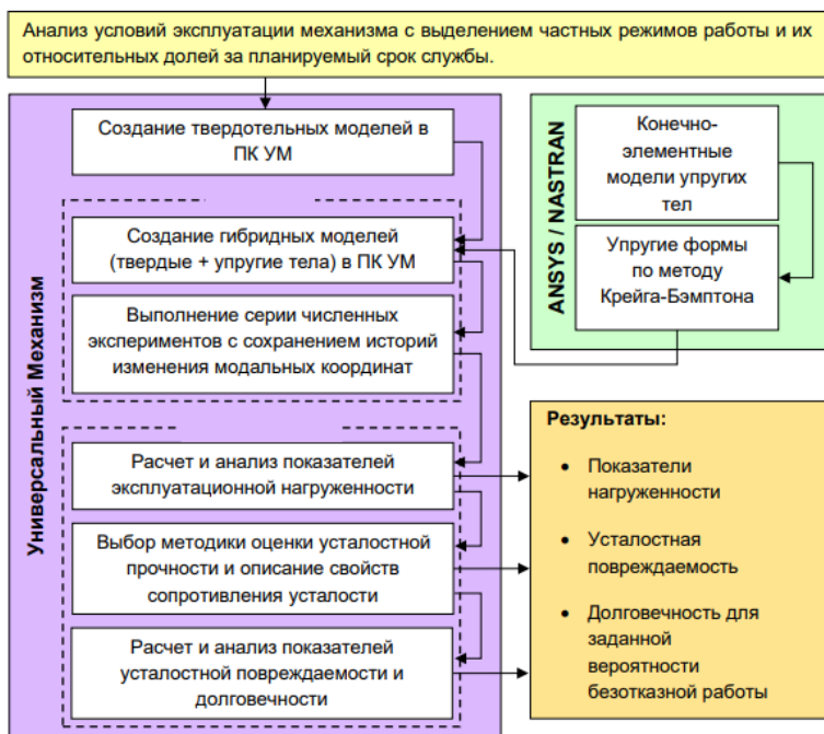
Рис. 14. Краткая схема расчёта нагруженности и усталостной долговечности
